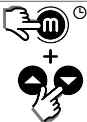
Continuando a tenere premuto il tasto premere contemporaneamente anche i tasti e . Sul display si visualizza per 2 secondi la scritta "AL" (allineamento) e, successivamente, il valore dell'allineamento inserito (il valore predefinito è 0).
