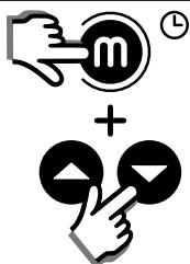
Trzymając wciśnięty klawisz , naciśnij jednocześnie klawisze i . Na wyświetlaczu pojawi się napis „AL” (korekta) przez 2 sekundy, a następnie rzeczywistą wartość korekty (wartość domyślna to 0).
