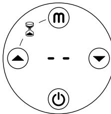
Wanneer het product is ingeschakeld, wordt het geactiveerd in de automatische modus. Het bericht "AU" wordt gedurende 3 seconden op het display weergegeven en daarna wordt de ingestelde temperatuur weergegeven:
