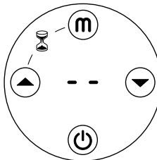
Po uruchomieniu się urządzenie jest w trybie Automatycznym. Na wyświetlaczu przez 3 sekundy widać napis "AU", po czym pokazuje się temperatura:
